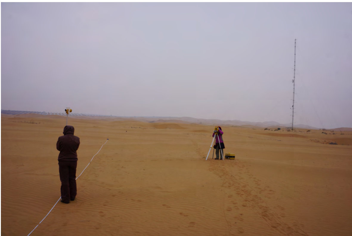
FIGURE 3.7 – Photographie du dispositif de mesure de la topographie. Pour effectuer ces mesures, nous nous déplaçons le long du transect avec un pas de 10 cm. (© Clément Narteau).
